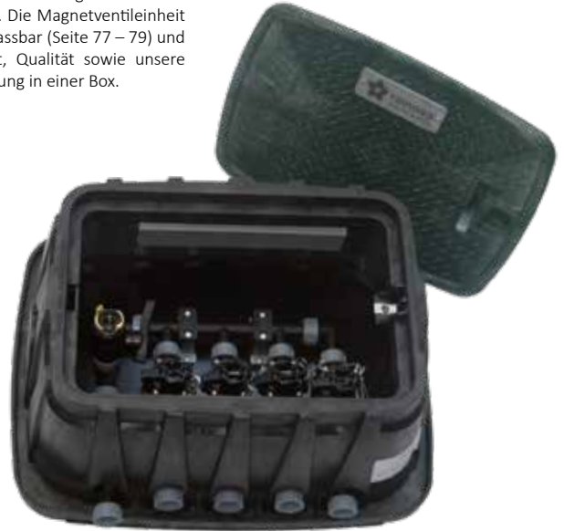
Verteilereinheit mit DOGRA-Verschraubungen, Absperrreinheit, Entleereinheit und Ventilkasten mit verschraubtem Boden vormontiert.
