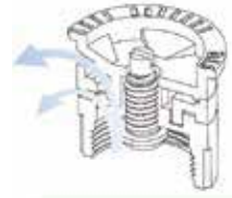
Zwei Öffnungen für gleichmäßige Verteilung
